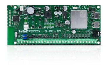
garantizando la continuidad de la comunicación: al surgir problemas de conexión con la red del primer operador, cambiará automáticamente a otra tarjeta.
